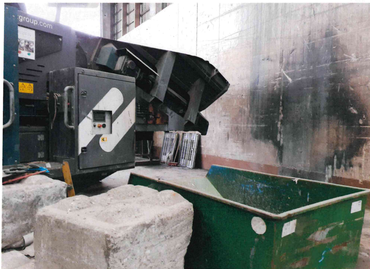
chaîne de tri située à proximité immédiate du départ de feu (trace sur le mur)
